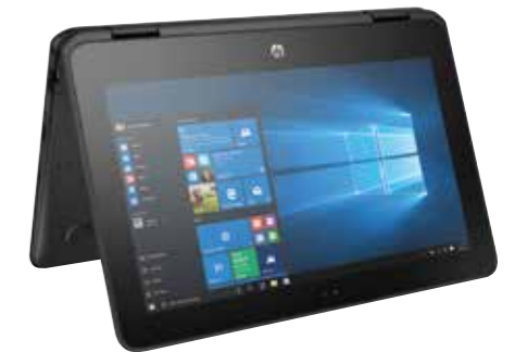
HP ProBook x360 11 G1 EE mit umlaufender Gummierung und Gorilla Glas
